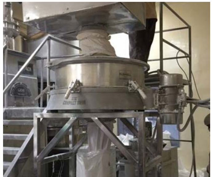
Foto 1. Pharmazeutische Pulver sieben mit dem Russell Compact Sieve® in der Sri Krishna Pharma Uppal Fabrik.
