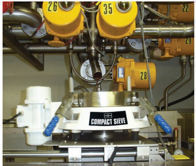
Figure 2: Les tamiseurs vibrants Russell Compact Sieve® s'intègrent parfaitement aux composants de réception du chocolat.
