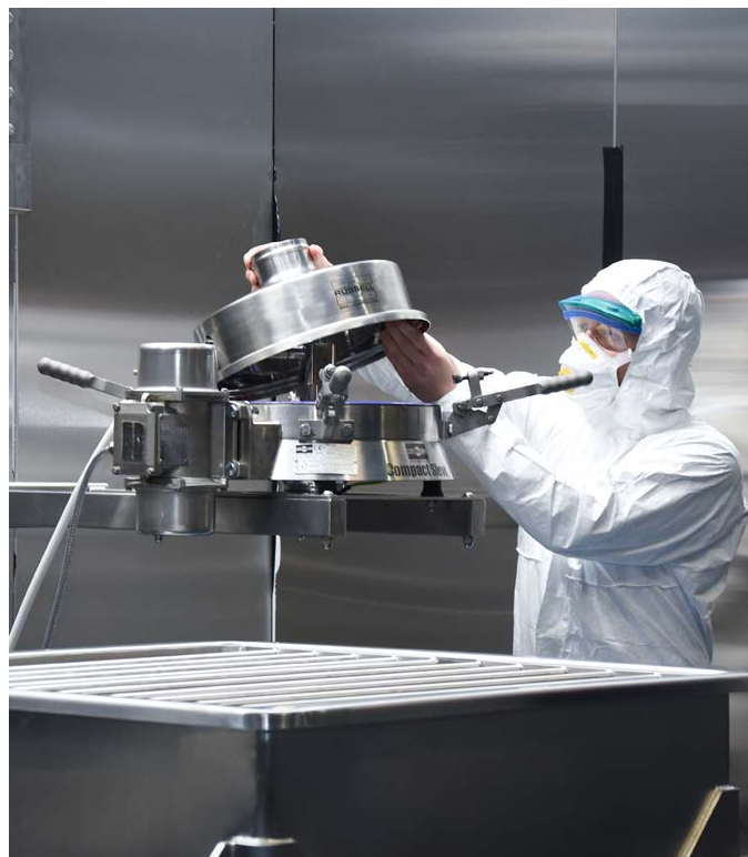
Figuur 4. De Russell Compact Sieve® is eenvoudig te demonteren en schoon te maken
