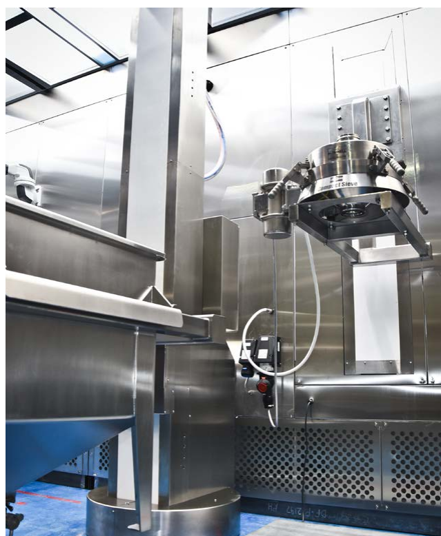
Figuur 1. Installatie van de Russell Compact Sieve® naast de opgeheven trechter
