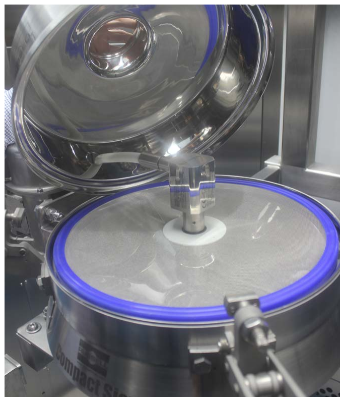
Figuur 3. De roestvrijstalen Russell Compact Sieve®
