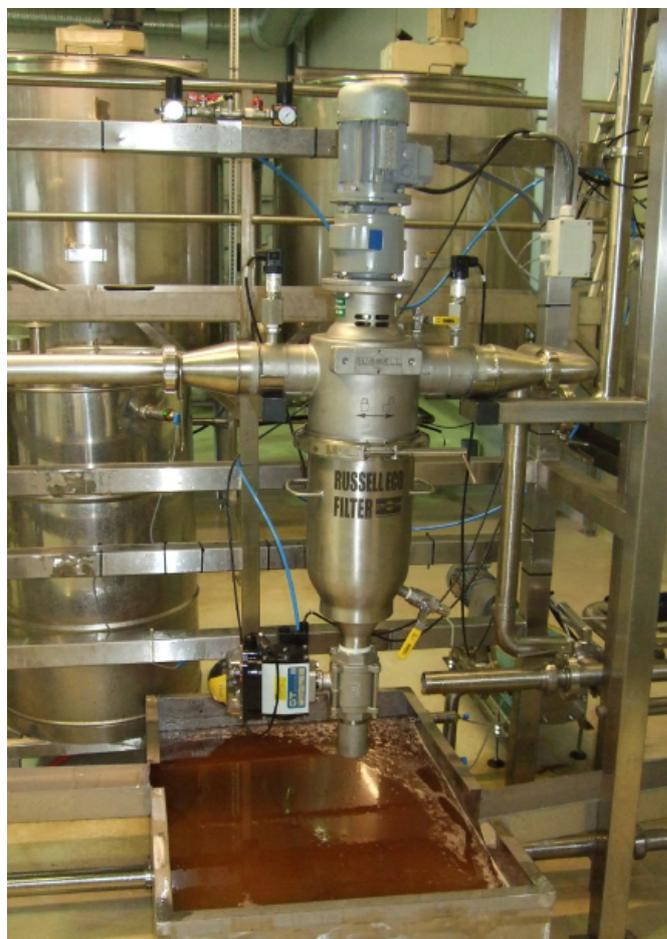
**Figura 2:** O Self Cleaning Russell Eco Filter® proporciona uma filtragem mais eficiente
