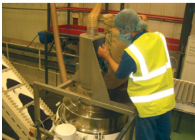
**Figura 3.** A estação de descarga da Compact 3in1 Sieve™ despejando sacos de chá de 75 kg.
