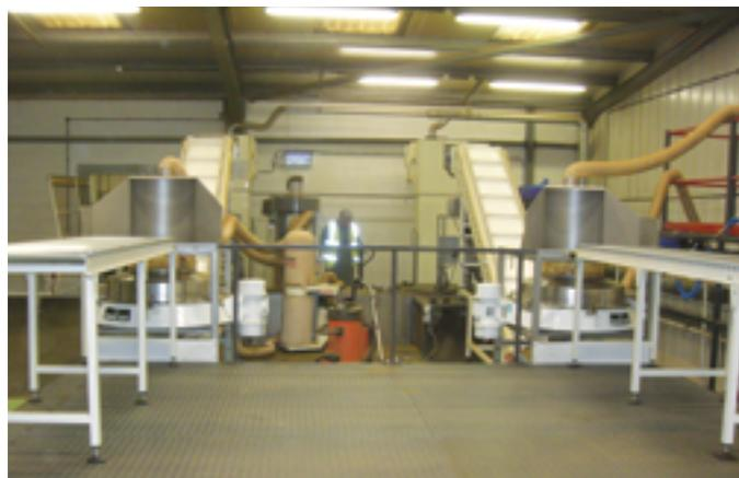
**Figura 2.** Duas Russell Compact 3in1 Sieve™ instaladas em linhas de produção idênticas
