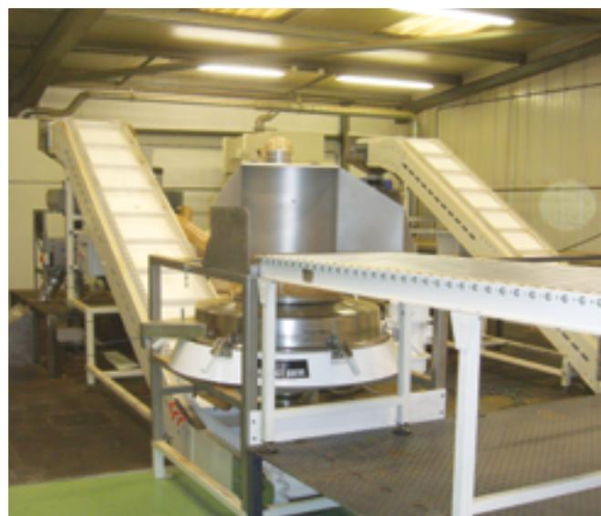
**Figura 1.** Uma das Russell Compact 3in1 Sieve™ instaladas na Clipper Teas
