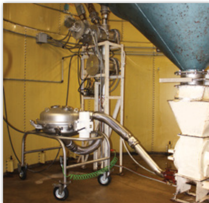
Figura 1. A Blow Thru Sieve peneirando o açúcar após ele passar por um silo
