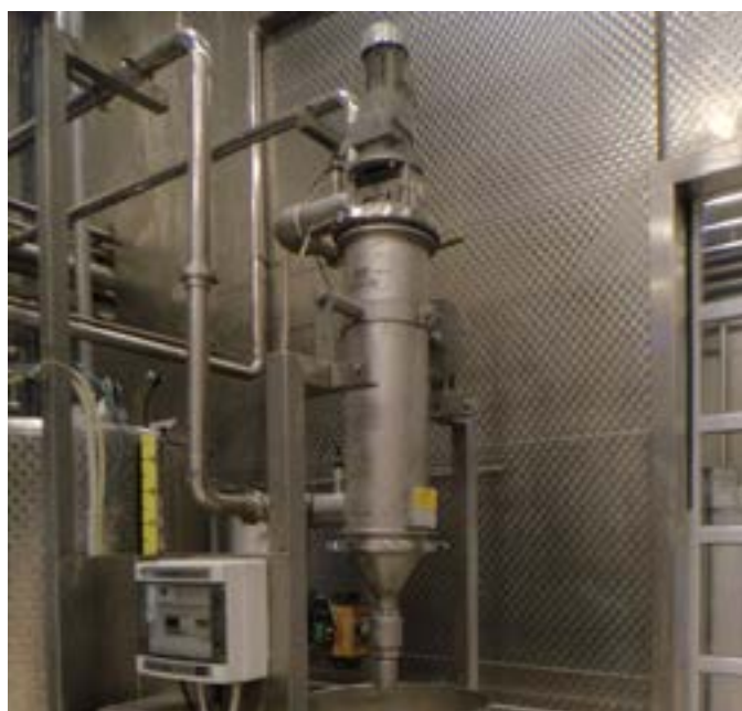
Figura 4. Um Self-Cleaning Russell Eco Filter® em linha instalado na Haitoglou Bros SA para garantir uma qualidade consistente de pasta tahine
