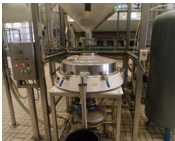
Figura 3. Uma Russell Compact Sieve® instalada na Haitoglou Bros SA para garantir a qualidade e a uniformidade das sementes de gergelim
