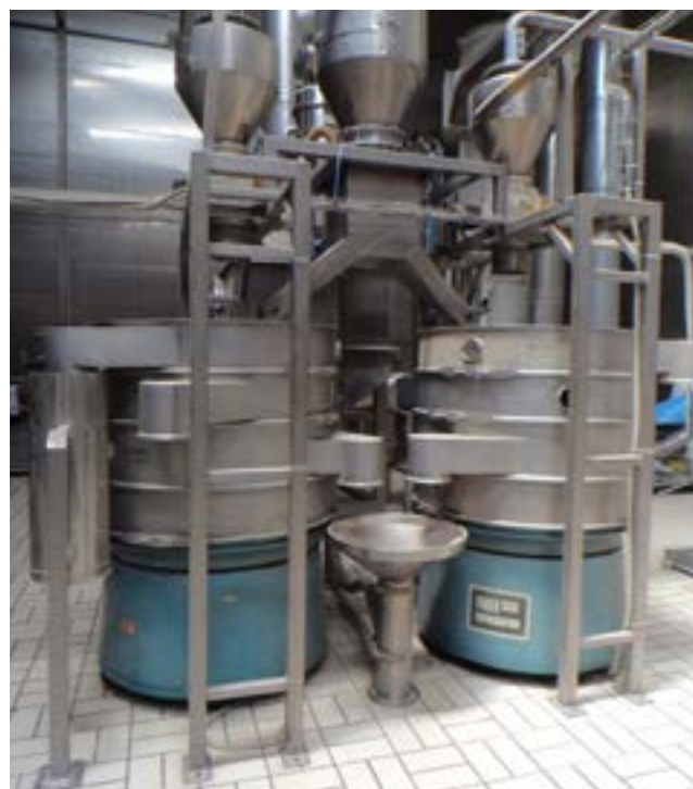
Figura 1. Instalação de duas unidades do Finex Separator™ na linha de produção de sementes de gergelim da Haitoglou Bros SA
