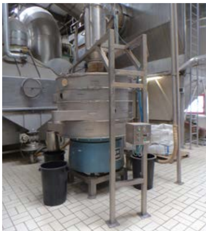
Figura 2. Um Finex Separator™ adicional instalado na linha de produção da Haitoglou Bros SA
