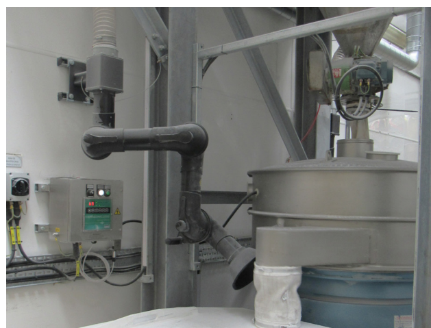
Figura 2. O Finex Separator™ aumentou significativamente a capacidade de peneiramento da linha de produção de polímeros em pellets
