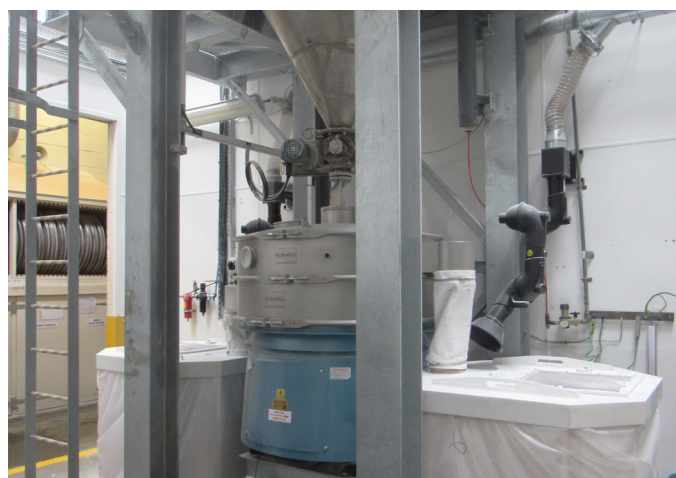
Figura 1. O Finex Separator™ com o Russell Vibrasonic® Deblinding System, instalados na Lucite International Group Ltd para assegurar exatidão da separação por tamanho de pellets de polímero
