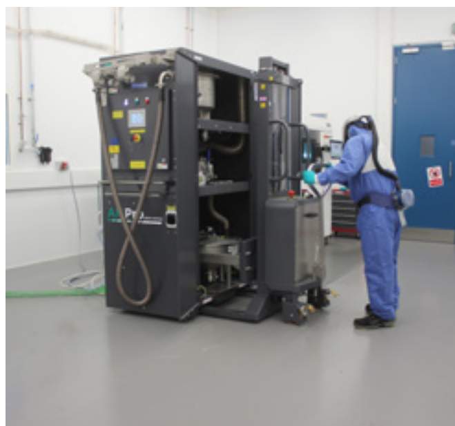
Figura 1. A Russell AMPro® Sieve Station é fácil de mover e operar, a fim de reutilizar e recuperar o pó AM do processo de construção.
