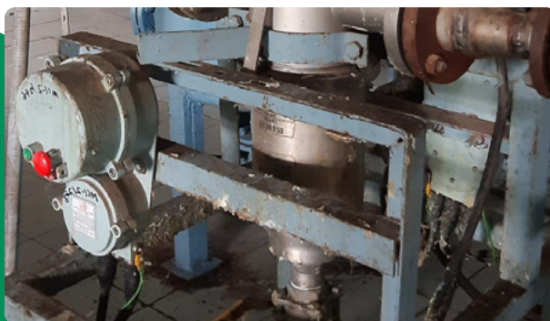
O filtro auto-limpante Russell Eco Filter ® é instalado na Zydex Indústrias para remover as impurezas dos aglutinantes de tintas
