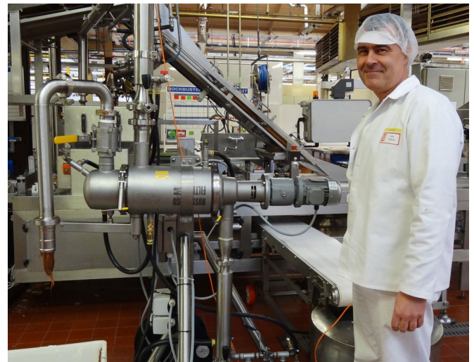
Abbildung 1. Der Self-Cleaning Russell Eco Filter®, installiert am Produktionsstandort in Herentals, Belgien
