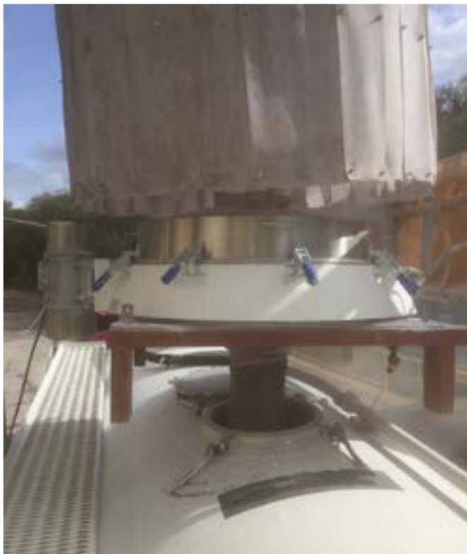
Abbildung 2. Das Russell Compact Sieve® gewährleistet die Qualität der Pulver während der Tankerbeladung
