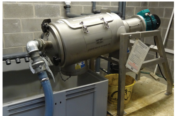
Abbildung 1: Der Russell Liquid Solid Separator™ installiert in einem Pferdesanierungszentrum, um das Washwasser effektiv zu reinigen
