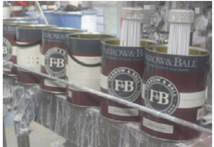
Figure 2. Farrow & Ball verwendet den selbstreinigenden Russell Eco Filter® zur Qualitätskontrolle flüssiger Farben vor dem Verpacken
