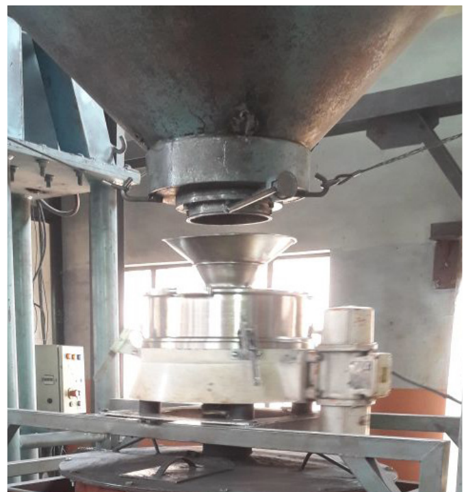
Abbildung 1. Installation des Russell Compact Sieve® bei Industrial Metal Powders (Indien) Pvt. Ltd.
