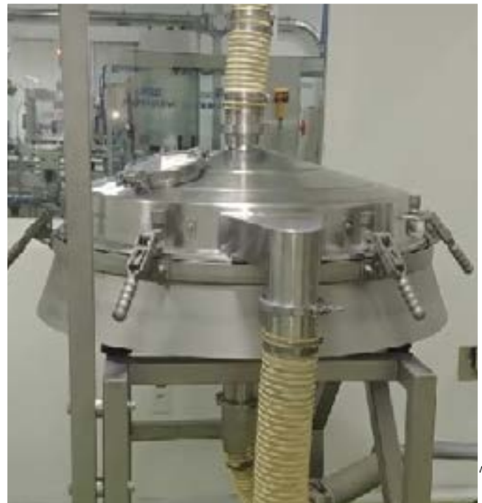
Abbildung 1. Das Russell Compact Sieve® - eine vielseitige Siebmaschine
