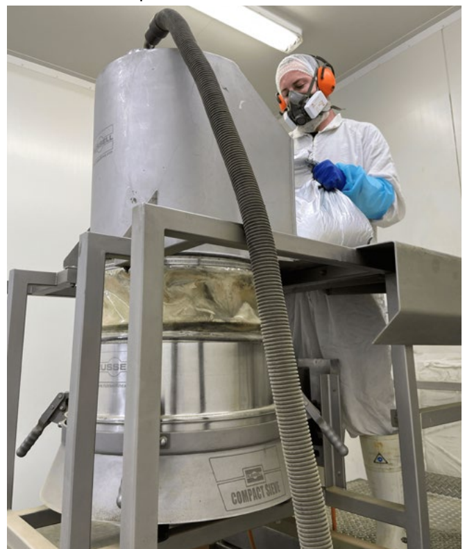
Abbildung 1: Bediener verwendet die Plattform zur Sackentleerung, um pharmazeutische Pulver im Russell Compact Sieve® zu sieben.
