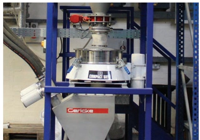
Figura 1. Una de las Russell Compact Sieves® instalados bajo una tolva en Altro.
