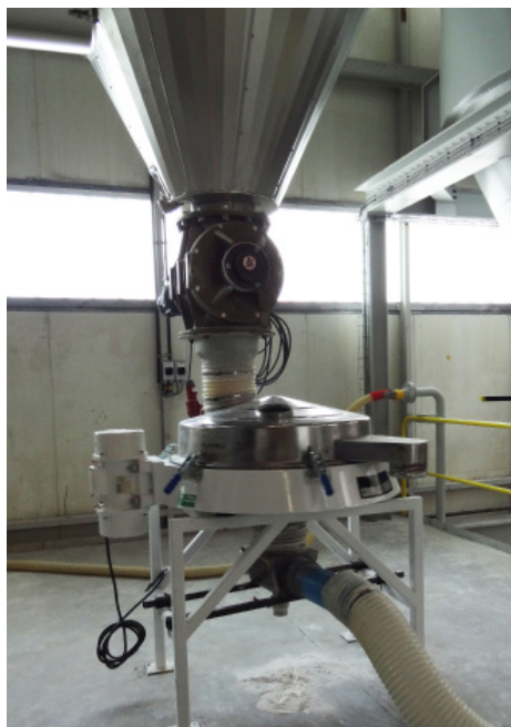
Figura 3. Instalación del Tamiz Russell Compact
