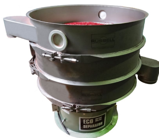
Figura 2. Un Russell Eco Separator® instalado en Eco Treasures, Bélgica para separar semillas y polvo de zumo congelado.
