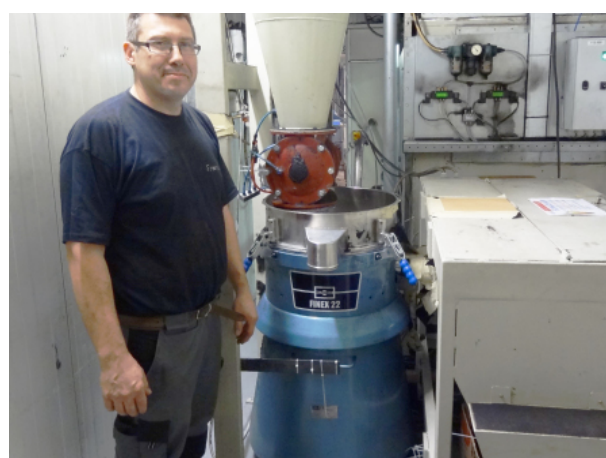
Imagen 1. A Finex 22 Sieve™, instalada en Fremach para optimizar el proceso de reciclado de flocado.
