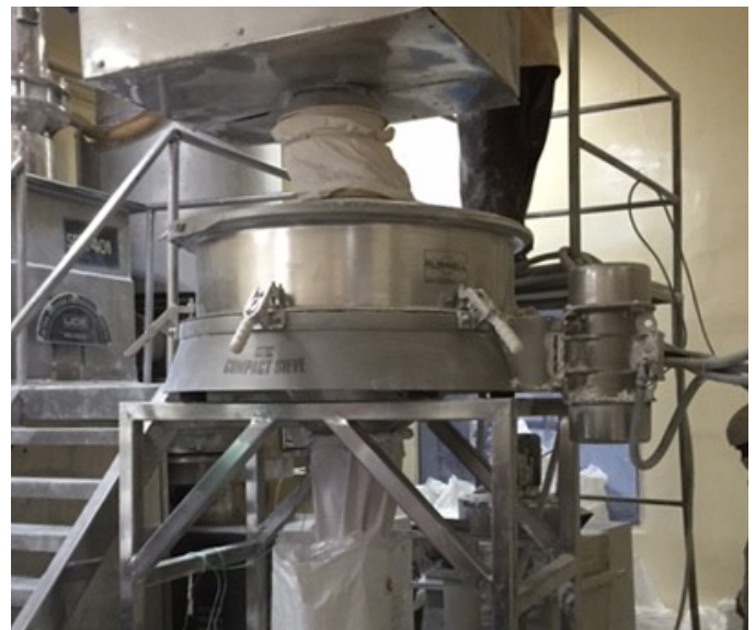
Figura 1: El Russell Compact Sieve® instalado para tamizar polvos farmacéuticos en la fábrica de Sri Krishna Pharma en Uppal
