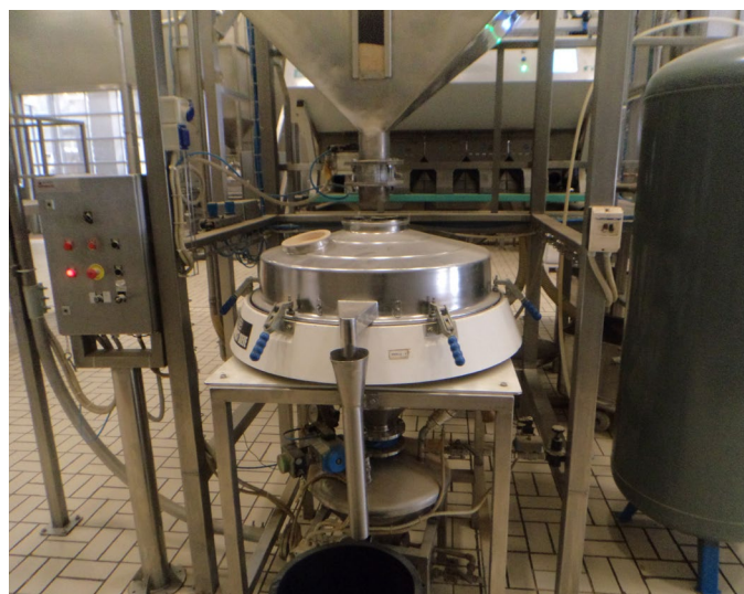
Figura 3. Un Russell Compact Sieve® instalado en Haitoglou Bros SA para garantizar la calidad y consistencia de las semillas de sésamo
