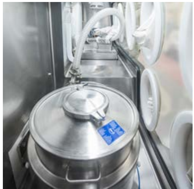
Imagen 1. Russell Compact Airswept Sieve™ se ajusta fácilmente dentro del Aislador de Contención
