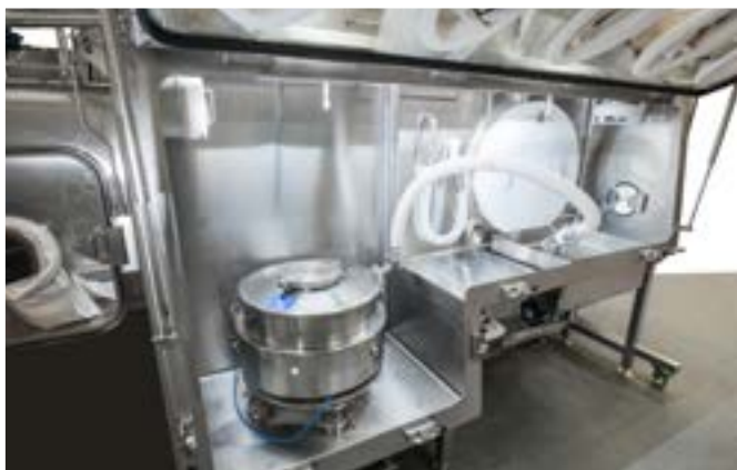
Imagen 2. Russell Compact Airswept Sieve™ con el sistema de cierre Russell Compact Airlock Sieve™ instalado en un Aislador de Alta Contención de Howorth
