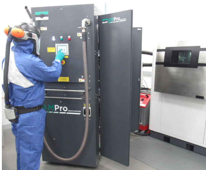
Figure 2. La clave de la Russell AMPro Sieve Station™ es cómo cada detalle ha sido diseñado e incorporado a un proceso totalmente automatizado de botón único.
