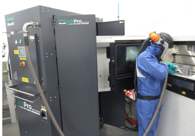
Figure 1. La Russell AMPro Sieve Station™ es utilizada para reciclar y recalificar los polvos AM del proceso de construcción en Progressive Technology.
