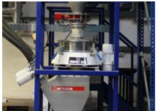
Figure 1 : Un des tamiseurs Russell Compact Sieve® installé sous une trémie chez les industries Altro.
