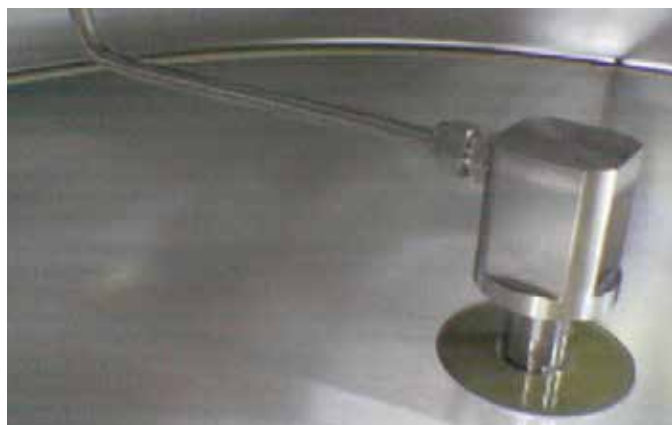
Figure 5 : La sonde Vibrasonic® agréée ATEX est certifiée pour l'utilisation en zones 20, 21, 22, 0, 1 et 2, et peut être installée sur tous les tamiseurs Russell Finex.
