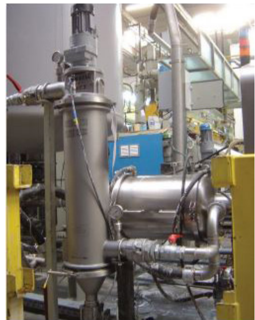
Image 1. L'un des quatre Self-Cleaning Russell Eco Filters® installés sur la chaîne de production Cushion Vinyl
