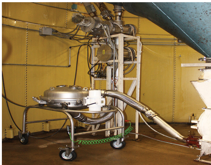
Image 1 : Le tamiseur Blow Thru Sieve tamise le sucre après son passage à travers un silo
