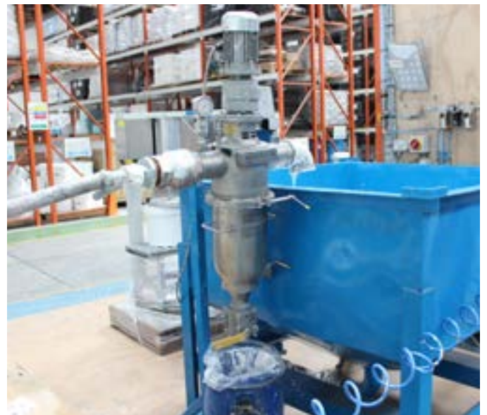
Figure 1: Filtre Self-Cleaning Russell Eco Filter ® installé à la société Flexcrete afin de filtrer la peinture liquide
