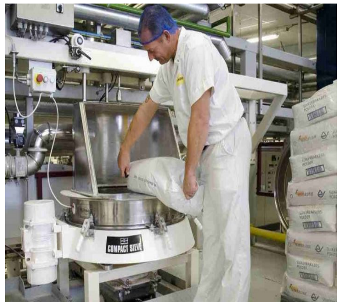
Image 1. Installation du tamiseur Russell Compact Sieve®
