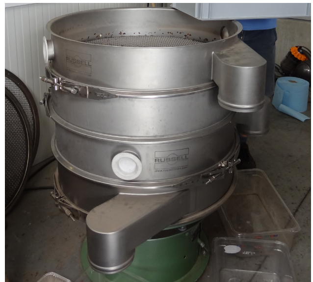
Image 1. L'installation du Russell Eco Separator® qui permettra de tamiser les larves en 4 fractions différentes
