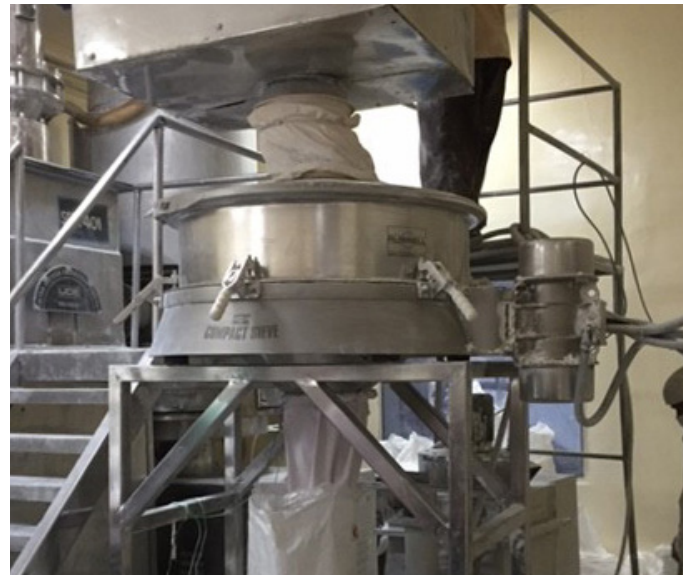
Image 1. Russell Compact Sieve® installé à Sri Krishna, l'usine d'Uppal pour tamiser poudres pharmaceutiques
