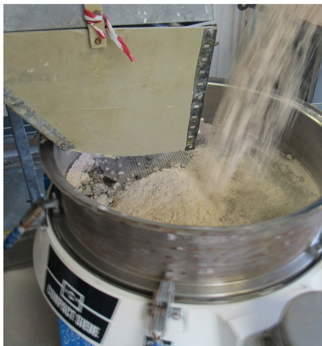
Figure 1. Le Russell Compact Sieve® installé sur une ligne de transport pour les matières premières entrantes chez Kemira Chemicals (UK) Ltd.
