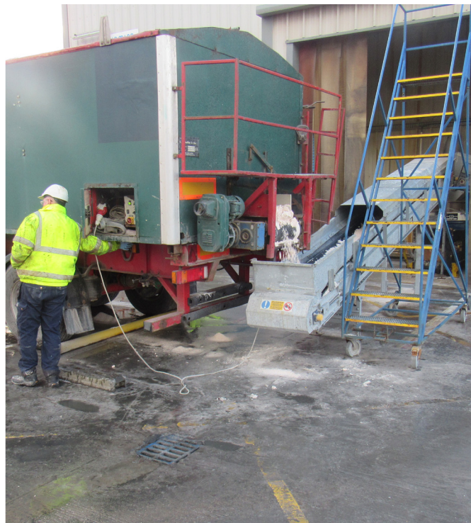
Figure 2. Le Russell Compact Sieve® est utilisé pour filtrer jusqu'à 48 tonnes de poudres entrantes par jour
