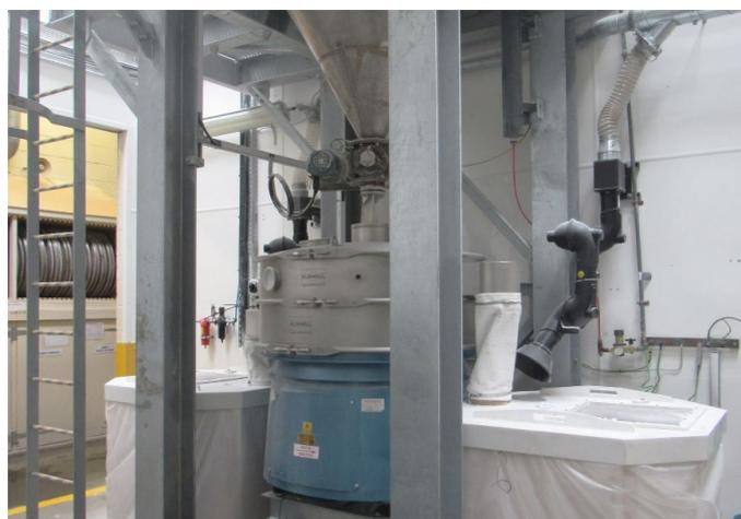
**Image 1.** Le Finex Separator™ avec Russell Vibrasonic® Deblinding System installé chez Lucite International Group Ltd pour garantir le classement précis des billes de polymère
