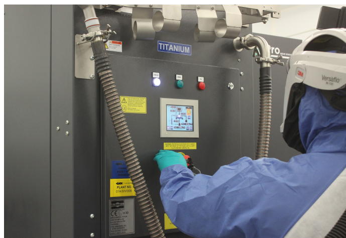
Abbildung 3. L'automatisation à un bouton est une caractéristique clé de la Russell AMPro® Sieve Station qui permet à l'opérateur de se concentrer sur d'autres tâches importantes.
