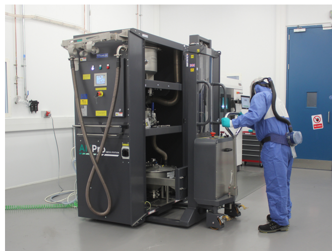
Photo 1. La Russell AMPro® Sieve Station est facile à déplacer et à utiliser, tout en permettant la récupération de poudre de fabrication additive lors du processus de construction.
