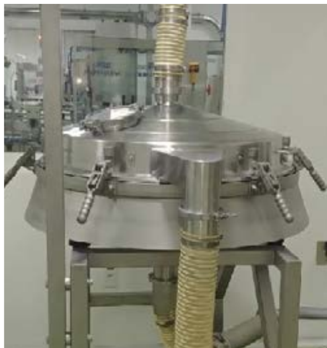
Figure 1. L'installation du Russell Compact Airswept Sieve™
