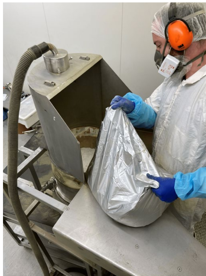
Image 2 : Le Russell Compact Sieve® a considérablement amélioré la capacité de tamisage des matériaux en poudre.
