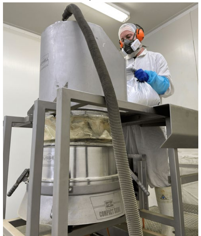
Image 1: Opérateur utilisant la plateforme de basculement de sac pour tamiser la poudre pharmaceutique dans le Russell Compact Sieve®
