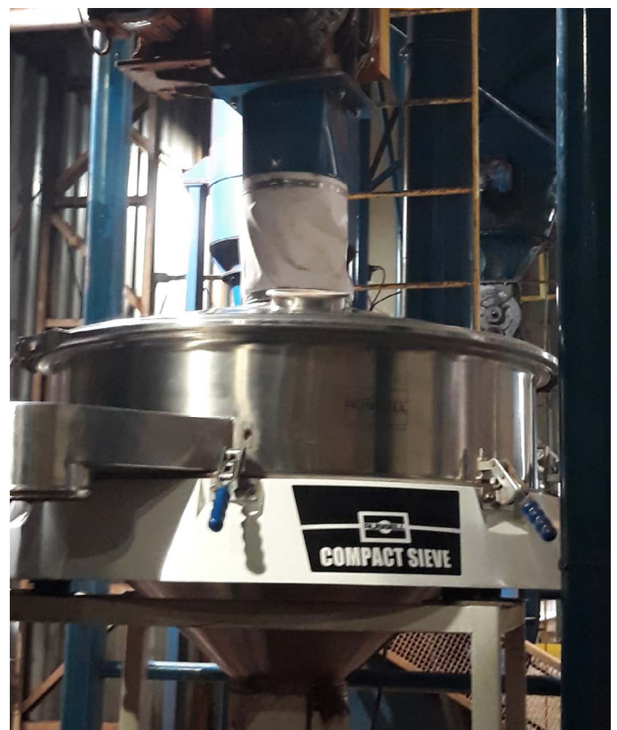
Fig. 1. Il Russell Compact Sieve® è utilizzato per rimuovere gli agenti contaminanti dai prodotti di cacao nell'impianto della IBC
