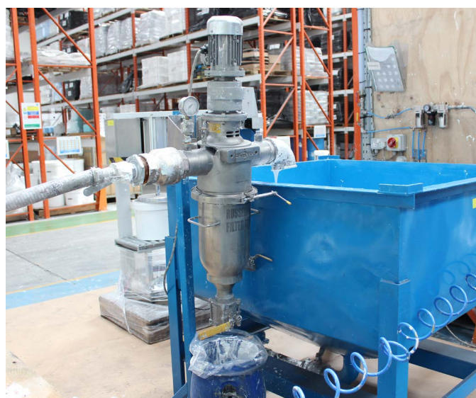
Figura 1. Il Russell Eco Filter® installato dalla Flexcrete per filtrare la vernice liquida.
