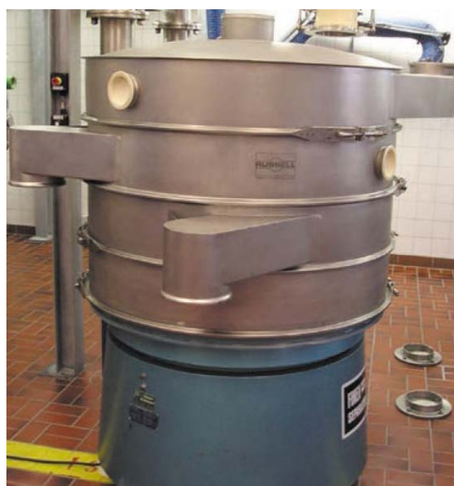
Foto 1. De Finex Separator™ in geïnstalleerd bij de fabriek van Kaul
