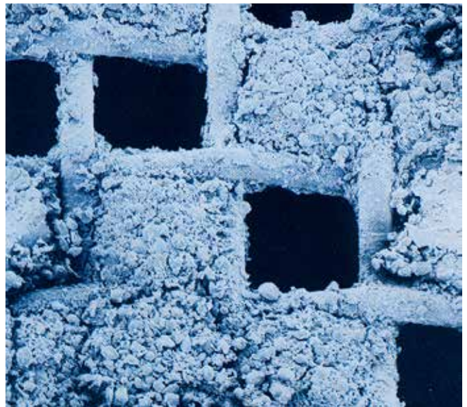
Afbeelding 4: Bij een typische werking van een zeef klonten deeltjes vaak samen en zorgen voor verstopping van het staalraadgaas. Ultrasonische ontstoppingsystemen kunnen dit probleem oplossen. (Bron: ter beschikking gesteld door van G. Bopp & Co. Ltd).
