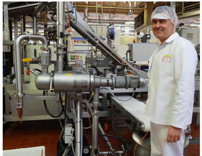
Afbeelding 1. Self-Cleaning Russell Eco Filter® gemonteerd in de fabriek van Mondelēz in Herentals, België
