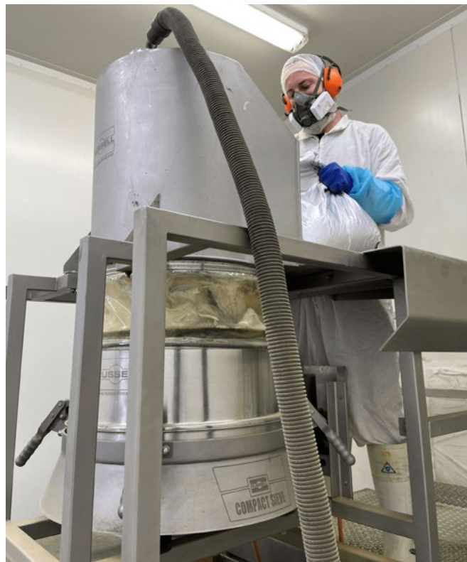
Afbeelding 1: Operator gebruikt een zakkantelplatform om farmaceutisch poeder te zeven in de Russell Compact Sieve®
