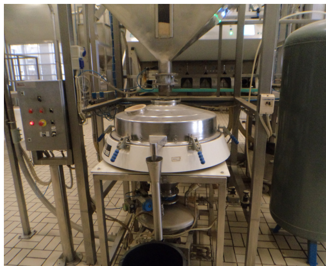
Figure 3. Russell Compact Sieve® zainstalowany w Haitoglou Bros SA aby zagwarantować jakość i konsystencję nasion sezamu
