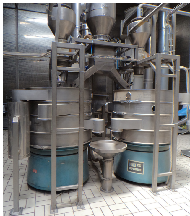
Figure 1. Instalacja dwóch maszyn Finex Separator™ w linii produkcyjnej nasion sezamu Haitoglou Bros SA
