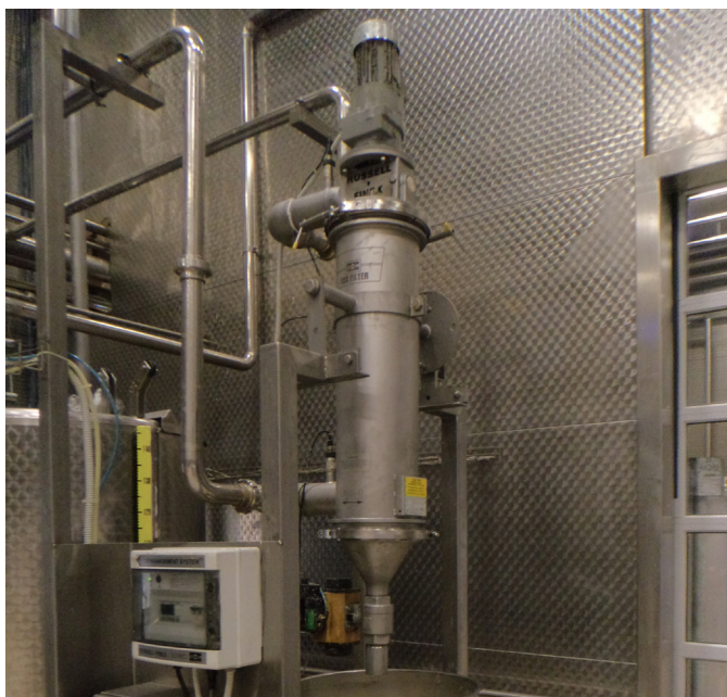
Figure 4. Zintegrowany z linią produkcyjną Haitoglou Bros SA, samoczyszczący filtr Russell Eco Filter® aby zagwarantować stałą jakość pasty tahini
