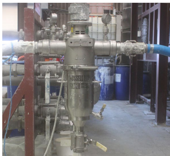
Figure 1. Self-Cleaning Russell Eco Filter® zainstalowany w fabryce Farrow & Ball w celu eliminacji niezdystrybuowanych pigmentów proszku z farby.
